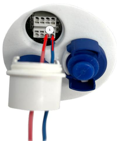
4. Fixez la calotte du dôme blanc ① en la faisant tourner dans le sens des aiguilles d'une montre.
