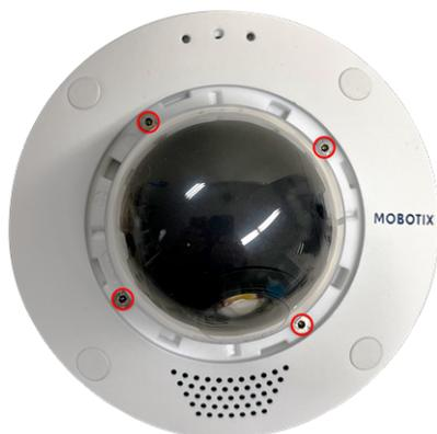
2. Fixez le cache de la bague de serrage ① en le faisant pivoter dans le sens des aiguilles d'une montre jusqu'à ce qu'une résistance se fasse sentir.
