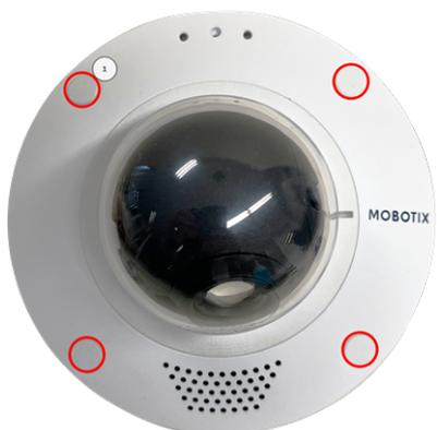
4. Fixez la caméra dans le In-Ceiling Set<sup>®</sup> à l'aide des quatre vis Allen I.3, p. 21 et d'une rondelle I.4, p. 21 fournies.
