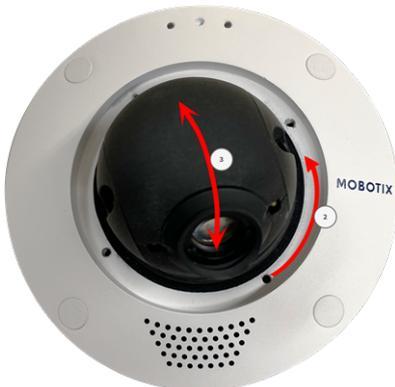
3. Serrez les deux vis Allen de part et d'autre de la monture d'objectif.
