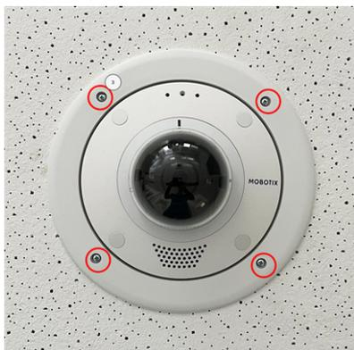
7. Insérez les bouchons en caoutchouc [M.7](#), p. 20 dans les trous de vis de la caméra.
