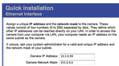
Fig. 79: Paramètres réseau dans l'interface Web de la caméra
