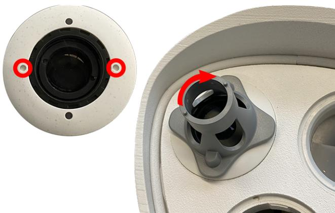
Fig. 14: Bloquez le module de capteur
