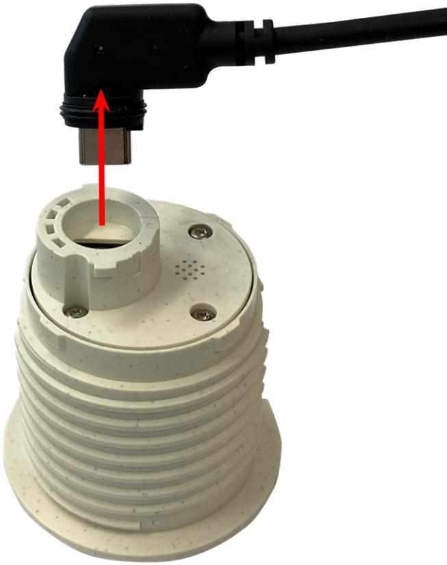
Fig. 22: Retirez le câble du module de capteur
