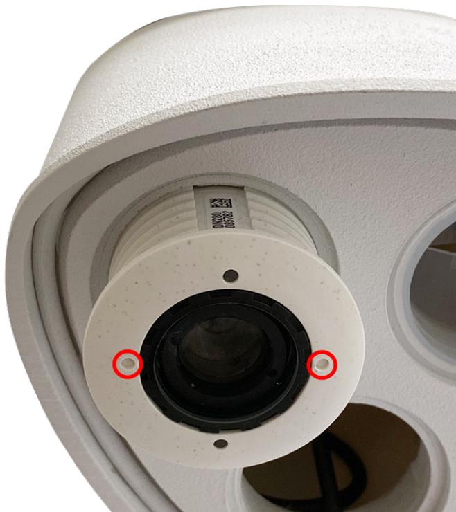
Fig. 13: Insérez un module de capteur dans le boîtier du module
