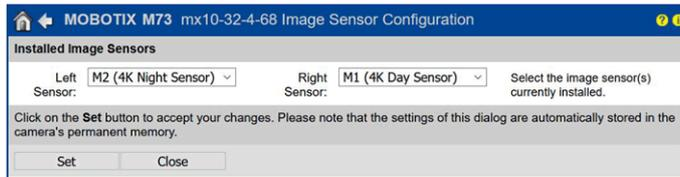
Fig. 90: Configuration des modules de capteurs
