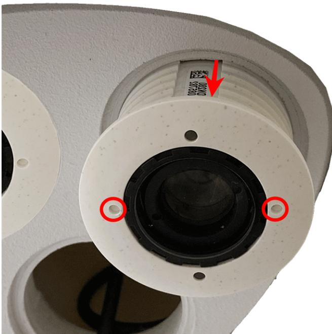
Fig. 24: Retirez le module de capteur du boîtier du module
