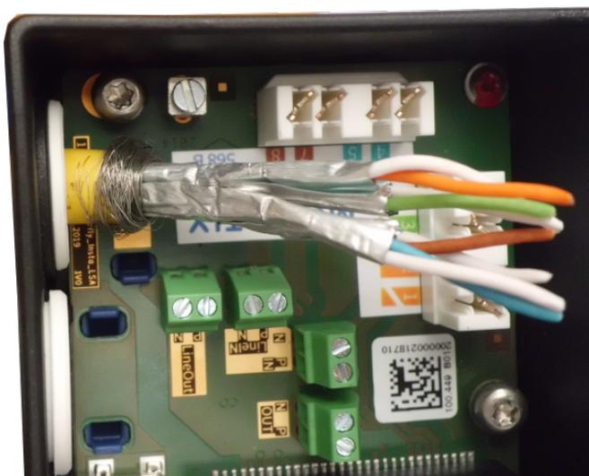
Fig. 57: Câble réseau inséré, bouchon correctement installé
