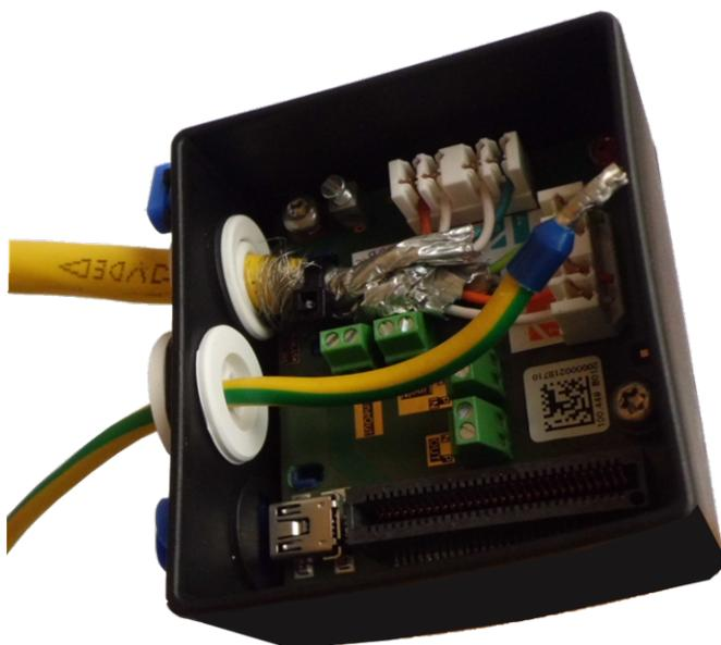
Fig. 62: Fil de terre inséré, bouchon correctement installé
