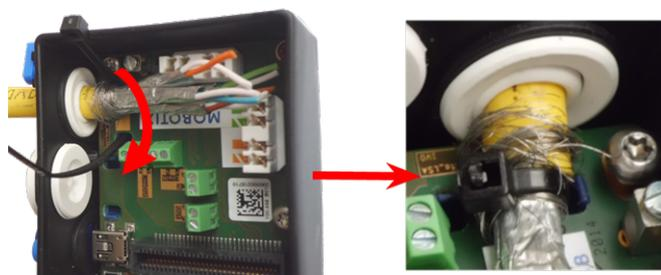
Fig. 58: Serre-câble inséré sous le câble réseau
