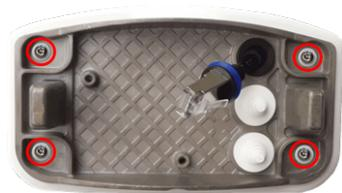
Fig. 37: Installé et prêt pour Connector Box RJ45
