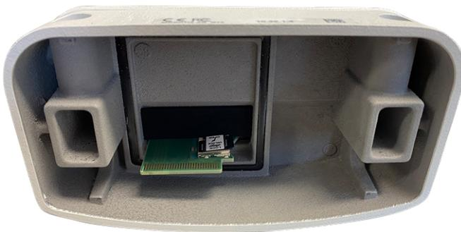
Fig. 95: Ouvrez le boîtier de la caméra
