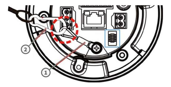
**AVIS!** Pour des raisons de sécurité, il est recommandé de fixer l'anneau anti-chute de la caméra ① à la chaîne anti-chute ② du pendant lors de l'installation de la caméra. Pour plus d'informations sur la chaîne anti-chute et le pendant, reportez-vous au document d'installation rapide correspondant disponible au point www.mobotix.com > Support > Centre de téléchargement > Marketing & Documentation > Manuels de la section *Accessoires SpeedDome*.
