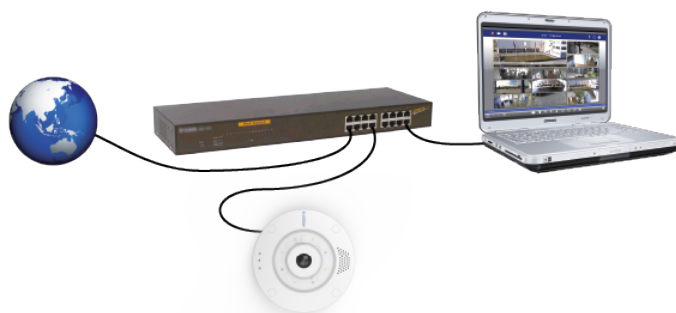
Abb. 17: Stromversorgung über PoE-Switch gemäß PoE Plus (802.3at-2009).
