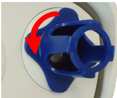
Abb. 52: Das Sensormodul bis zum Anschlag gegen den Uhrzeigersinn drehen
