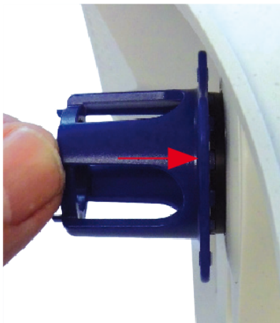
Abb. 56: Drücken Sie fest, um das Schutzglas einzusetzen, und drehen Sie es, um es zu verriegeln.
