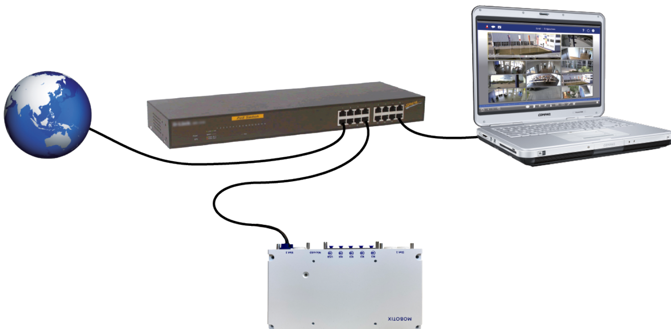
Abb. 40: Stromversorgung über PoE-Switch gemäß PoE Plus (802.3at-2009)
