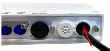
Abb. 41: Drücken Sie den Stecker fest ein, bis der blaue Dichtring einrastet.
