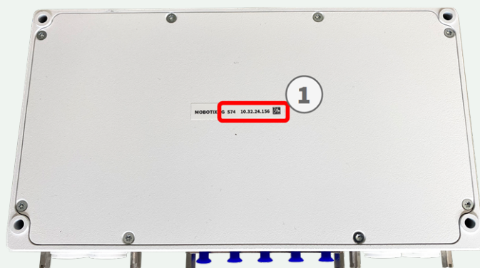
Abb. 8: IP-Adresse auf der Rückseite des Kameragehäuses
