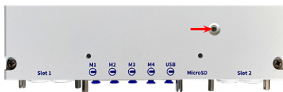
Abb. 43: Kamera-LED am Kameragehäuse
