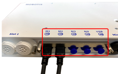
Abb. 38: 4 Modulsteckeranschlüsse und 1 USB-C-Schnittstelle
