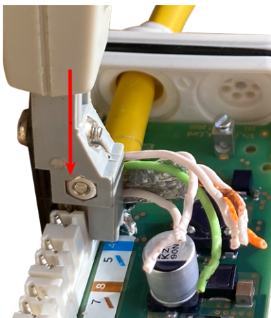
Abb. 26: Mit Krone LSA-Plus-Anlegewerkzeug angeschlossenes Netzkabel
