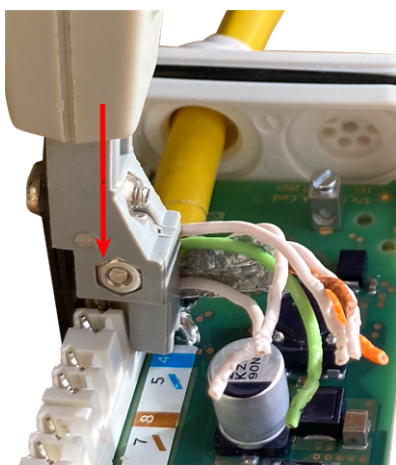
Fig. 26: Cables de red conectados mediante la herramienta LSA+/Krone
