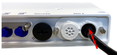
Fig. 41: Presione el enchufe firmemente hasta que la junta tórica azul encaje en su sitio.
