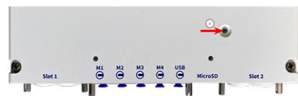
Fig. 43: LED de la cámara en la parte superior del chasis de la cámara
