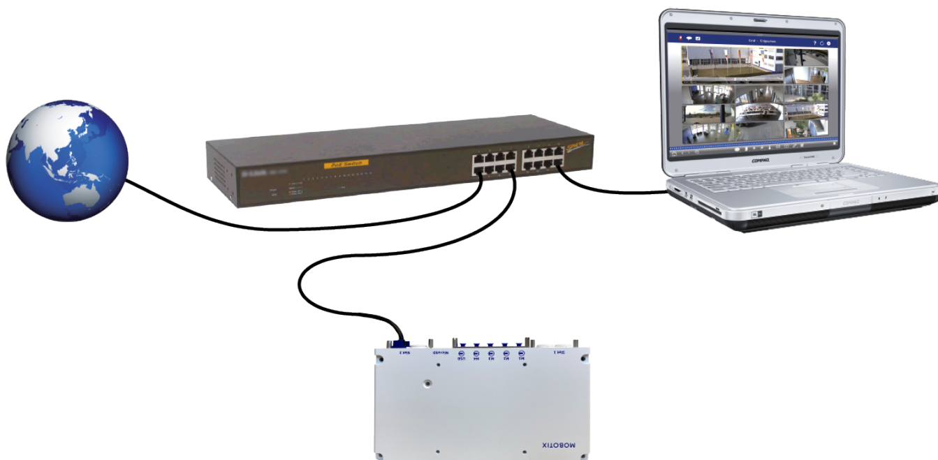
Fig. 40: Fuente de alimentación mediante un conmutador PoE según la PoE Plus (802.3at-2009)
