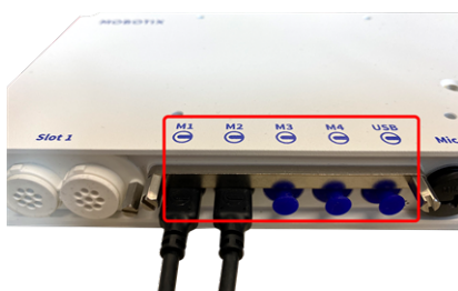
Fig. 38: 4 puertos de conexión de módulos y 1 interfaz USB-C
