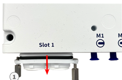
Fig. 32: Retirez le cache du logement de la carte d'interface
