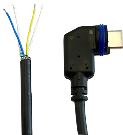
Fig. 36: Câble audio avec deux paires de fils
