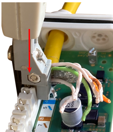
Fig. 26: Fils réseau connectés à l'aide de l'outil LSA+/Krone
