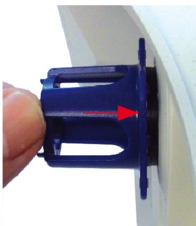
Fig. 56: Appuyez fermement pour insérer le verre de protection de l'objectif et tournez pour le verrouiller
