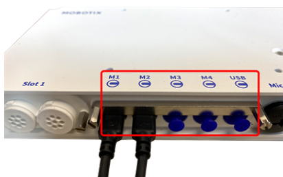
Fig. 38: 4 ports de connecteur de module et 1 interface USB-C
