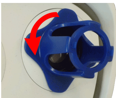
Fig. 52: Tournez le module de capteur à fond dans le sens inverse des aiguilles d'une montre
