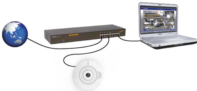
Abb. 17: Stromversorgung über PoE-Switch gemäß PoE Plus (802.3at-2009).
