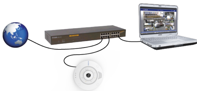
Fig. 17: Alimentation électrique à l'aide d'un commutateur PoE conformément à PoE Plus (802.3at-2009).
