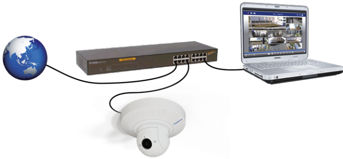
Abb. 17: Stromversorgung über PoE-Switch gemäß PoE Plus (802.3at-2009).
