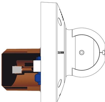
**Fig. 6: Vista lateral de MOBOTIX p71 sobre la toma de corriente de montaje empotrado**
