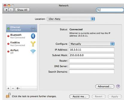
Fig. 20: Configuración de red en equipos MacOS
