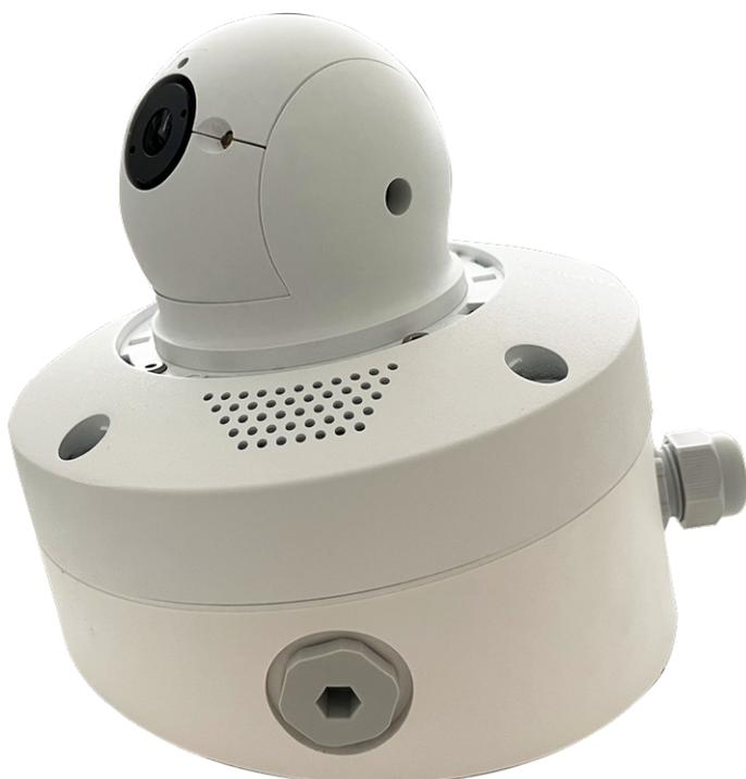
**ATENCIÓN!** Antes de montar la cámara, asegúrese de que en la posición de montaje hay disponible una conexión de red con una fuente de alimentación de acuerdo con el estándar PoE Plus (802.3at-2009) (consulte [Conexión de la cámara a la red](#)).
