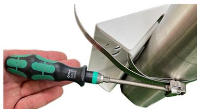
**Fig. 14: Ajuste de las correas**
