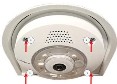
11. Introduzca los tapones de caucho [M.7, p. 19](#) en los agujeros para tornillos de la cámara (① y ② en la figura anterior).
