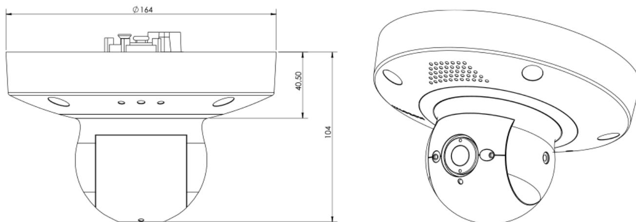
Fig. 5: MOBOTIX p71: Todas las medidas en mm
