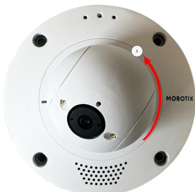
2. Afloje los cuatro tornillos de fijación del anillo de sujeción con la llave Allen [Materiales de montaje: Alcance de la entrega](#), p. 19 suministrada .
