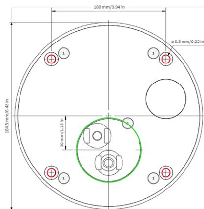
**Fig. 7: Gabarit de perçage avec trous pour le positionnement des vis de fixation (cercles rouges) et pour la prise murale encastrée (cercle vert)**
