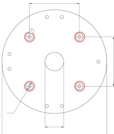
3. Si vous utilisez le kit à 0°, fermez les ouvertures de câble ② qui ne sont pas nécessaires avec les bouchons de fermeture inclus. Fixez chacun d'eux par l'intérieur à l'aide d'un petit écrou hexagonal.
