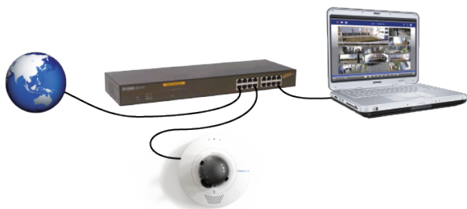
Abb. 17: Stromversorgung über PoE-Switch gemäß PoE Plus (802.3at-2009).
