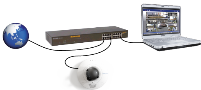
Fig. 17: Alimentation électrique à l'aide d'un commutateur PoE conformément à PoE Plus (802.3at-2009).
