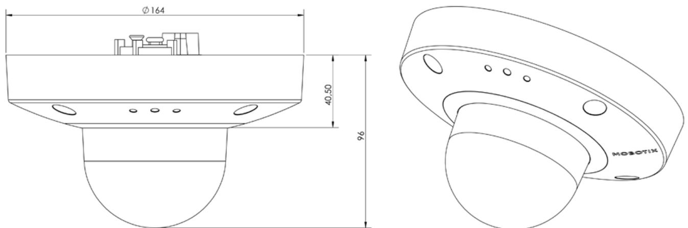
Fig. 1: MOBOTIX D71: Todas las medidas en mm
