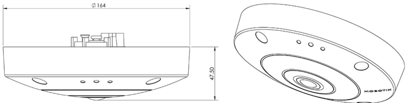
Fig. 1: MOBOTIX c71: Todas las medidas en mm
