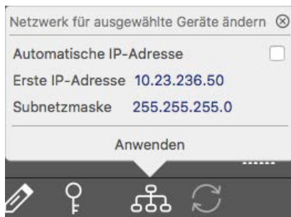
Fig. 24: Modifier réseau des dispositifs sélectionnés
