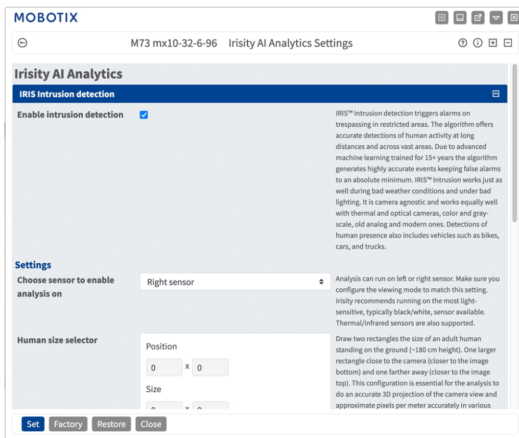
Fig. 14: Mode d'exploitation standard : Détection d'intrusion IRIS
