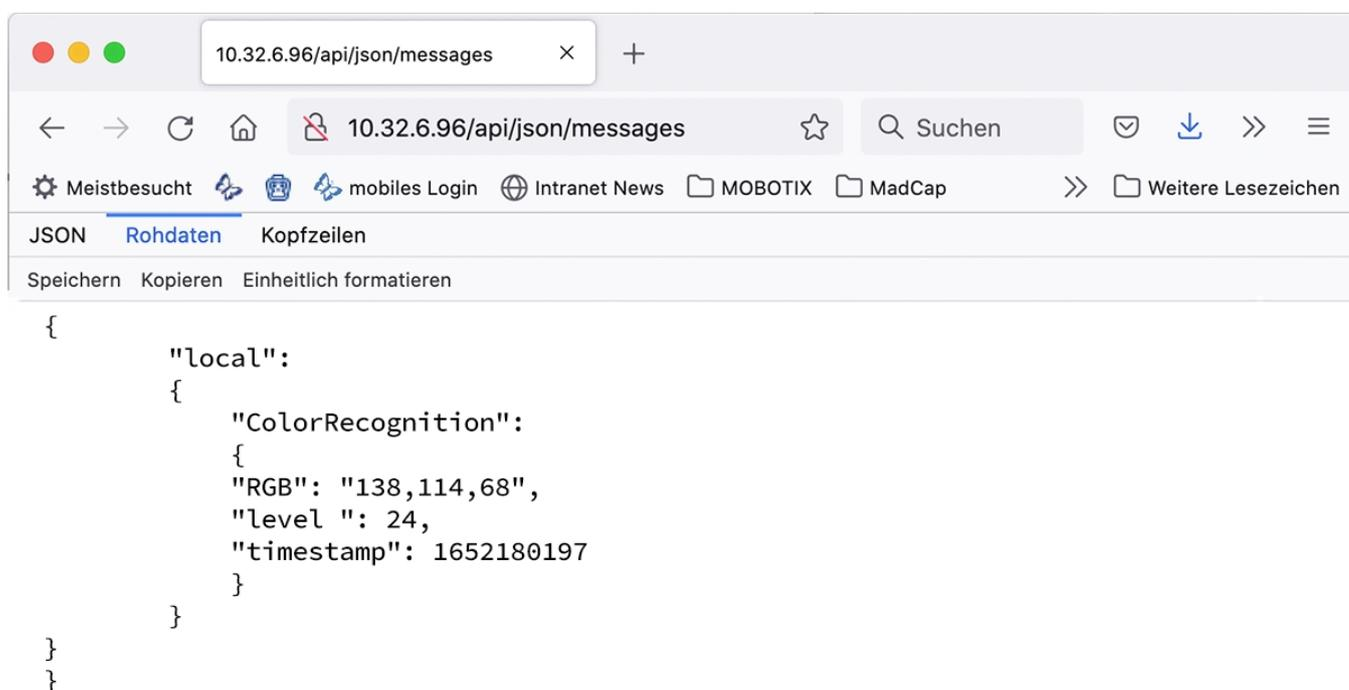
Fig. 19: Esempio: metadati trasmessi all'interno di un MxMessage di MOBOTIX ActivitySensor AI App
