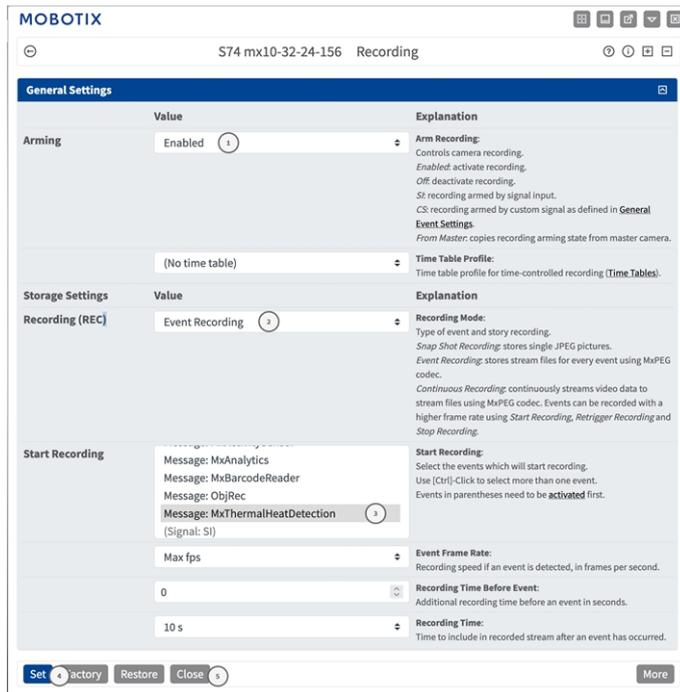
Fig. 27: Configuration des paramètres d'enregistrement de la caméra
