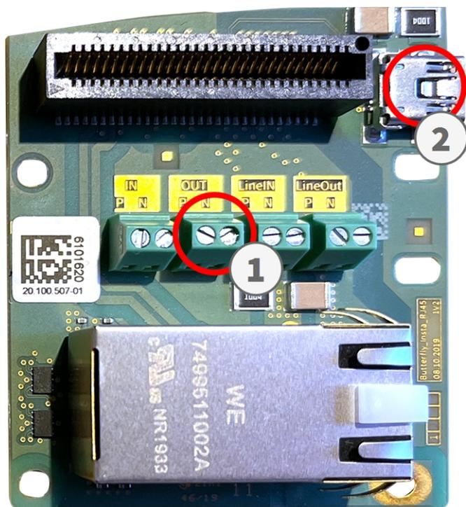
Fig. 5: Connexion compatible CNPP au M73 Connector Box RJ45
