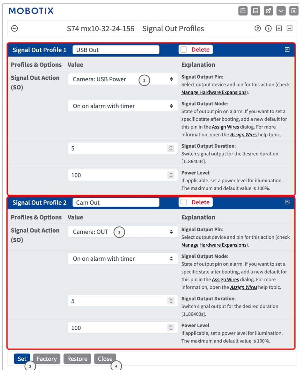
Fig. 17: Définition des profils de sortie de signal
