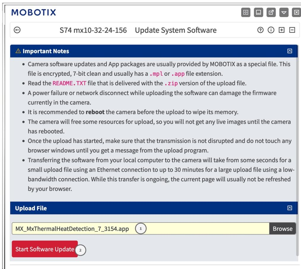
Fig. 15: Installation d'une application P7 MOBOTIX
