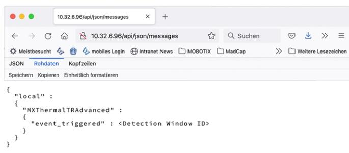
Fig. 28: Exemple : Métadonnées transmises dans un message MxMessage de MOBOTIX Thermal-Heat-Detection App
