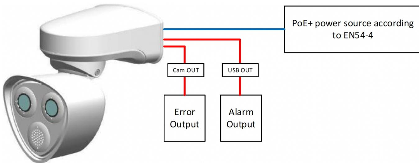
Fig. 4: Installation compatible CNPP du MOBOTIX M73
