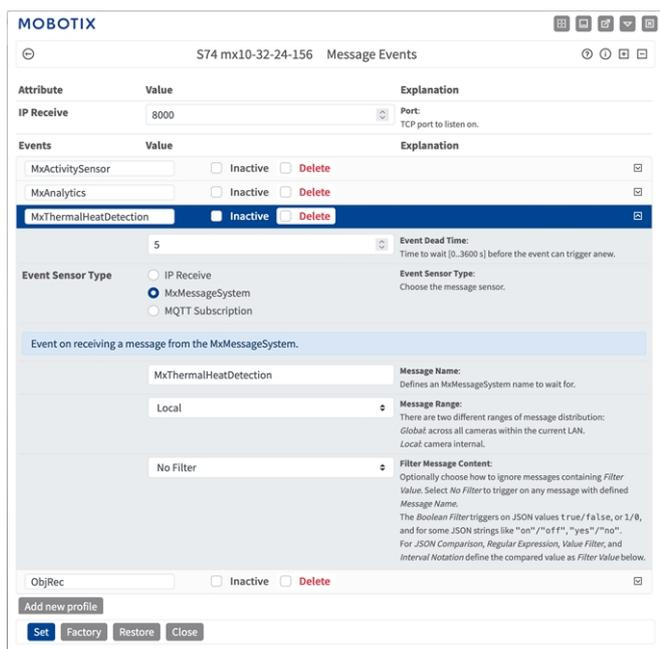
Fig. 23: Exemple : Détails d'événement de message générique - aucun filtre
