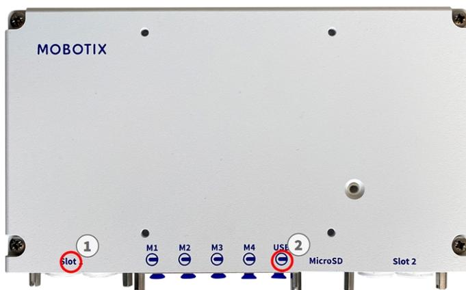
Fig. 3: Connexion compatible CNPP à la caméra S74
