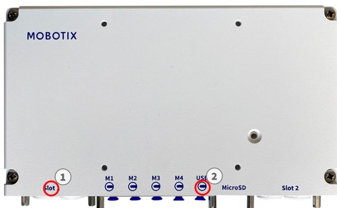
Fig. 3: Collegamento conforme a CNPP per la videocamera S74
