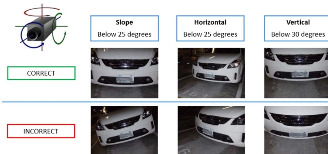
Fig. 11: Ángulo de rotación máximo
