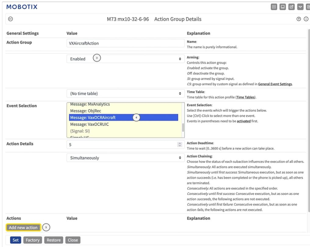
Fig. 26: Configuración de un grupo de acciones
