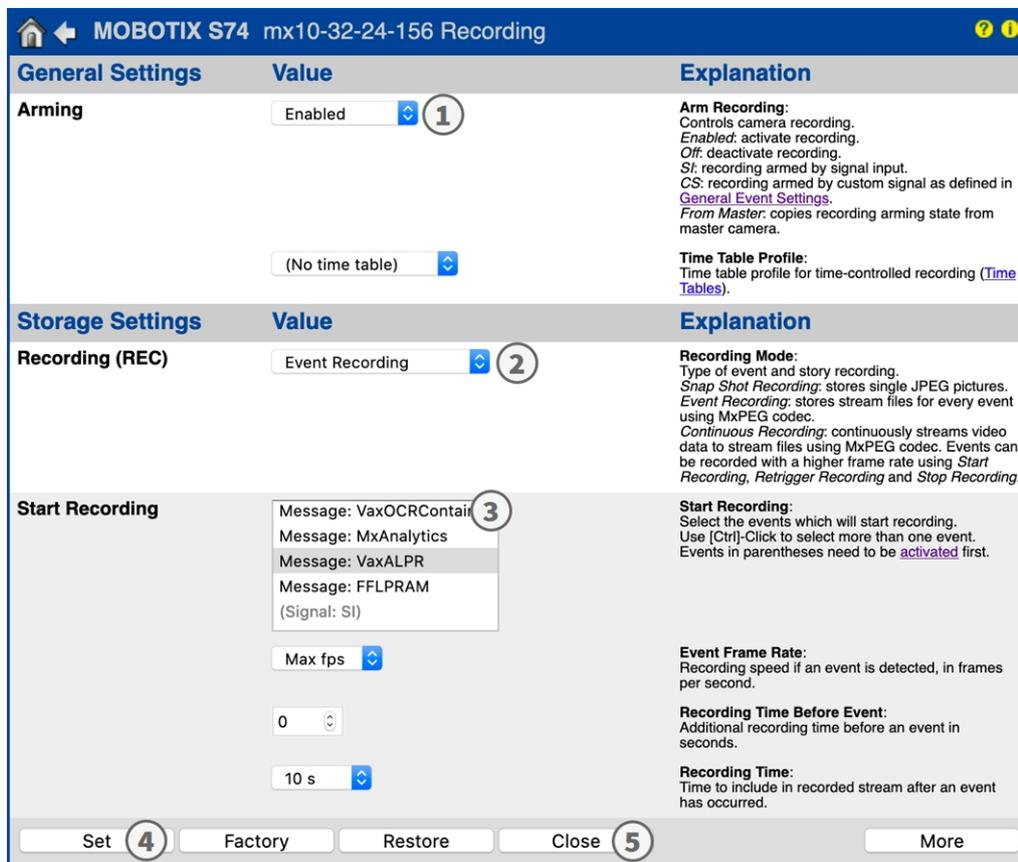
Fig. 25: Configuration des paramètres d'enregistrement de la caméra
