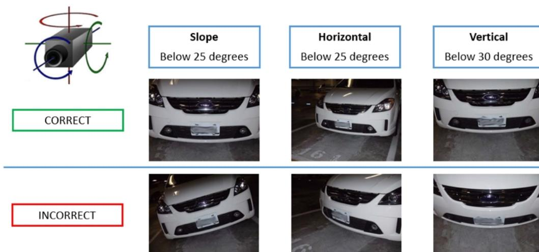
Fig. 11: Angle de rotation maximal
