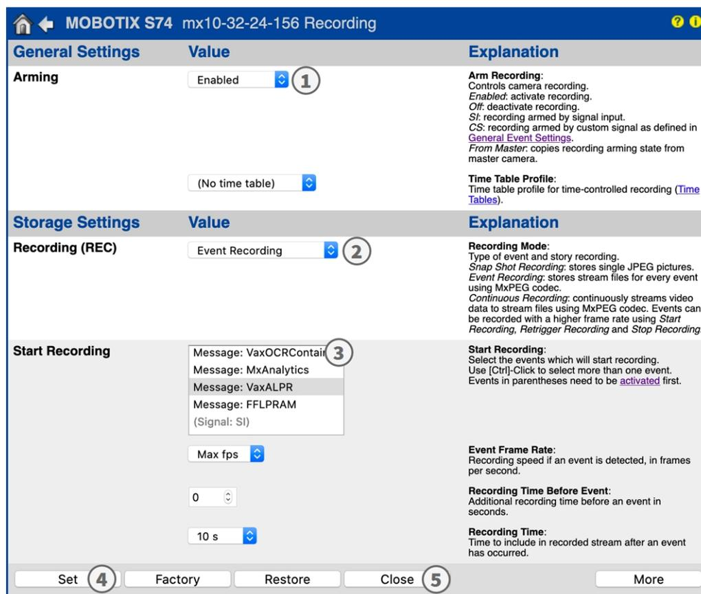
Fig. 29: Configuration des paramètres d'enregistrement de la caméra
