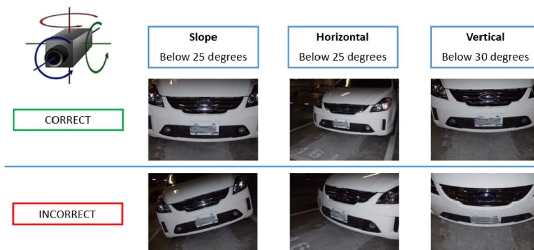
Fig. 11: Angolo di rotazione massimo
