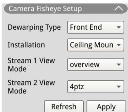
Mit dem NVR können Benutzer je nach DSP der Kamera zwischen Backend-Dewarping und Frontend-Dewarping als Dewarping-Typ wählen. Wählen Sie den Fischaugen-Kamerakanal aus, und klicken Sie links auf **Kamera-Fischaugen-Einstellung**, um die Einstellungen anzuzeigen.
