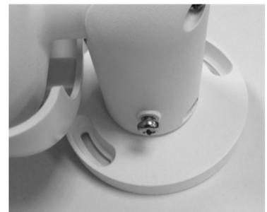
2. Wenn die Löcher für die Schrauben durch das Kameragehäuse verdeckt sind, lockern Sie die in der rechten Abbildung dargestellte Schraube, lösen Sie sie jedoch nicht. Drehen Sie dann das Kameragehäuse so, dass Sie die Löcher für die Schrauben erreichen können.
