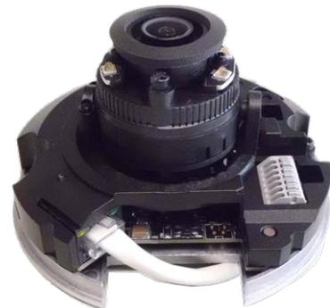
6. Haga coincidir los dos orificios de los tornillos de la cámara con los tacos de plástico en el lugar de instalación. Fije la cámara con los tornillos autorroscantes suministrados.
