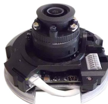
6. Faites correspondre les deux trous de vis sur la caméra avec les vis d'ancrage en plastique à l'emplacement d'installation. Fixez la caméra à l'aide des vis autotaraudeuses fournies.
