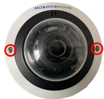
2. Placez la caméra à l'emplacement d'installation (lors de l'installation de la caméra sur un mur, l'entrée de câble doit toujours se trouver en bas). Marquez la position des deux trous de vis, indiqués par les cercles rouges dans la figure, sur le plafond ou le mur (la flèche rouge indique l'endroit où le câble Ethernet entre dans la caméra).
