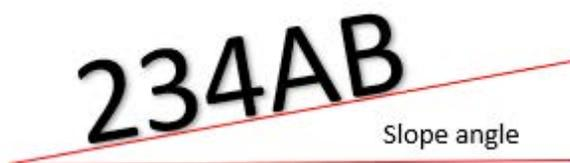
**AVISO!** Si ya sabe que las matrículas van a estar inclinadas, puede establecer este parámetro en un valor superior para obligar al motor que busque formas de matrícula más inclinadas. Sin embargo, debe configurar su cámara ALPR para mantener las matrículas lo más cerca posible de la horizontal.
