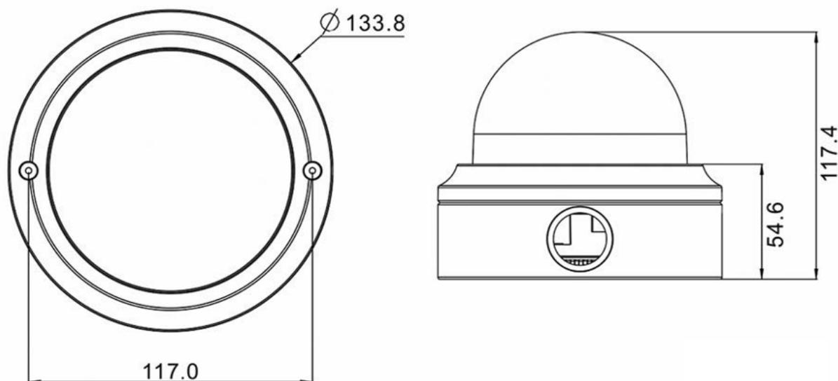
Fig. 1: 2MP Vandal Dome Camera: Tutte le misurazioni in mm
