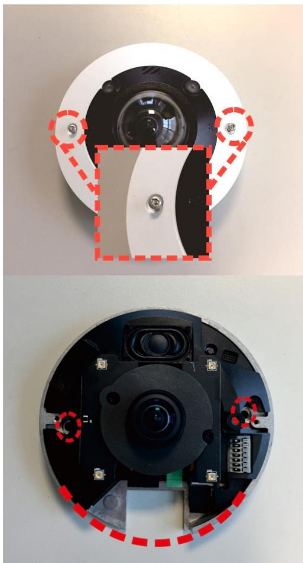
2. Coloque la cámara en el lugar de instalación. Marque la posición de los dos orificios para tornillos indicados en la figura de la derecha en el techo o la pared. A continuación, dibuje una línea a lo largo del borde cóncavo de la cámara para indicar la posición del cable.
