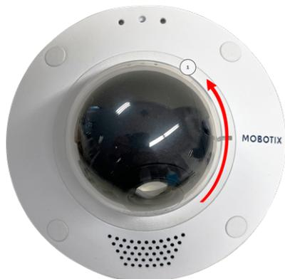
2. Lösen Sie die vier Befestigungsschrauben vom Spannring mit dem mitgelieferten Inbusschlüssel [Montagezubehör: Lieferumfang, p. 19](#) und ziehen Sie dann vorsichtig die Kuppel ab.
