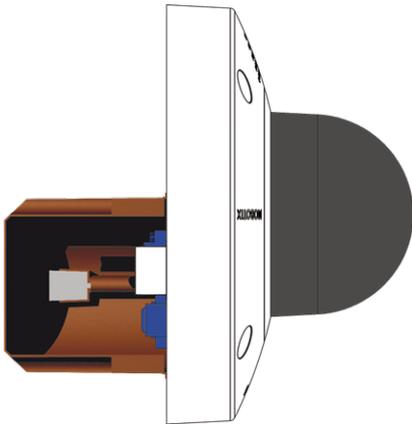
**Abb. 6: Seitenansicht der MOBOTIX D71 über Unterputzsteckdose**
