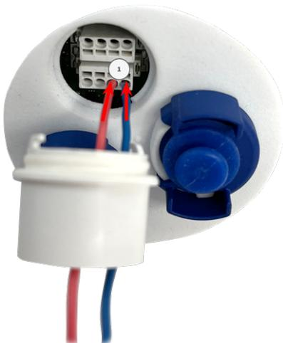
4. Befestigen Sie die weiße Kappe ①, indem Sie sie im Uhrzeigersinn drehen.
