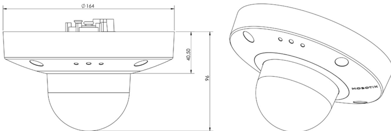
Abb. 5: MOBOTIX D71: Alle Maßangaben in mm
