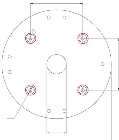
3. Wenn Sie das 0-Grad-Set verwenden, schließen Sie die nicht benötigten Kabelöffnungen ② mit den beiliegenden Verschlussstopfen. Befestigen Sie die einzelnen Komponenten von innen mit einer kleinen Sechskantmutter.
