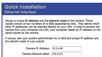
Abb. 22: Netzwerkeinstellungen in der Weboberfläche der Kamera
