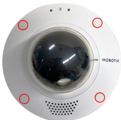
9. Befestigen Sie die Kamera mit dem mitgelieferten Innensechskantschlüssel [W.2, p. 20](#) an der Bodenplatte des On-Wall Set mit vier Innensechskantschrauben [W.5, p. 20](#) und je einer Unterlegscheibe [W.6, p. 20](#).
