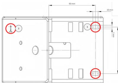
2. Bohren Sie die Löcher mit einem 10-mm-Wandbohrer und setzen Sie die mitgelieferten Dübel in die gebohrten Löcher ein.
