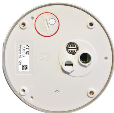
3. **Entriegeln Sie den microSD-Kartenhalter:** Klappen Sie die Metallabdeckung ② der microSD-Karte nach oben (z. B. mit dem Fingernagel).
