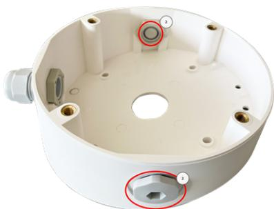
4. Bringen Sie die Kabelverschraubung ③ so an die Kabelöffnung des On-Wall Set an, dass sich die schwarze Gummidichtung außen befindet. Befestigen Sie ihn von innen mit einer kleinen Sechskantmutter.
