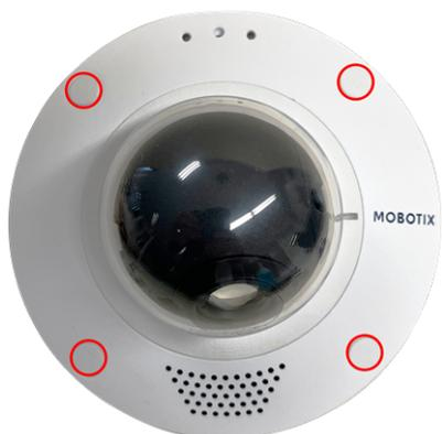
4. Befestigen Sie die Kamera mit den vier mitgelieferten Innensechskantschrauben [I.3](#), p. 21 und je einer Unterlegscheibe [I.4](#), p. 21 im In-Ceiling Set ②.
