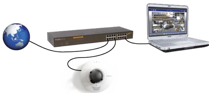
Abb. 17: Stromversorgung über PoE-Switch gemäß PoE Plus (802.3at-2009).
