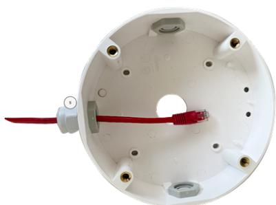
7. Verbinden Sie das Netzkabel vor Ort mithilfe eines Standardanschlusses mit dem Kamera-Patchkabel. Überschüssiges Kabel kann problemlos im On-Wall Set aufbewahrt werden (siehe [Anschließen der Kamera, p. 53](#)).
