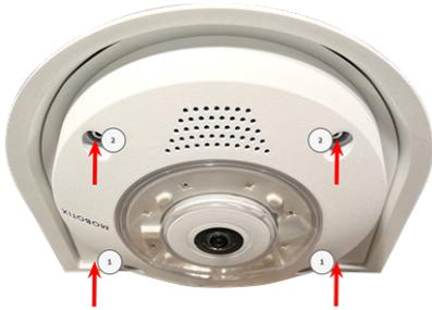
11. Drücken Sie die Gummistopfen [M.7, p. 19](#) in die Schraubenlöcher der Kamera (① und ② in der Abbildung oben).
