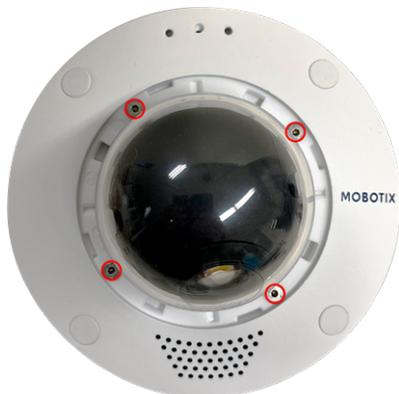
2. Coloque la cubierta del anillo de sujeción ① girándola hacia la derecha hasta que note resistencia.
