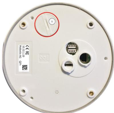
3. **Desbloquee el soporte de la tarjeta microSD:** Levante la cubierta metálica ② de la tarjeta microSD (por ejemplo, con la uña).
