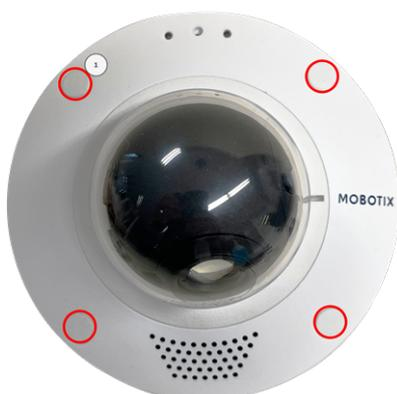
9. Con la llave Allen [W.2, p. 20](#) suministrada, fije la cámara a la placa inferior de On-Wall Set con cuatro tornillos Allen [W.5, p. 20](#) y una arandela [W.6, p. 20](#) cada uno.
