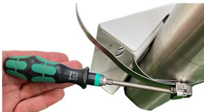
Fig. 14: Ajuste de las correas
