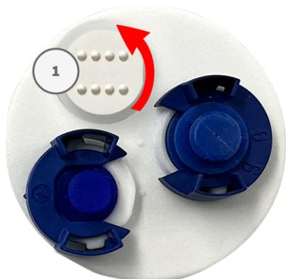
2. Introduzca los cables de los dispositivos de E/S por las aberturas existentes en la tapa del domo.
