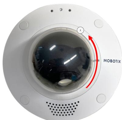
2. Desserrez les quatre vis de fixation de l'anneau de serrage à l'aide de la clé Allen [Accessoires de montage : contenu de la livraison, p. 19](#) Accessoires de montage : contenu de la livraison, p. 19 fournie, puis retirez délicatement le dôme.
