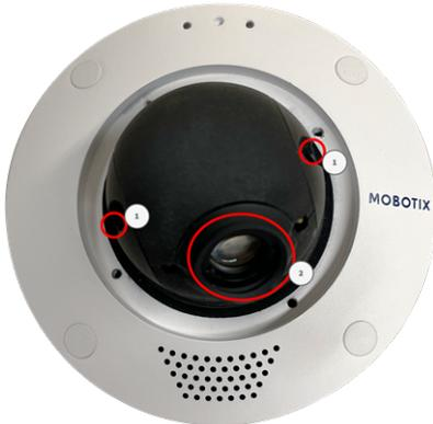
2. Orientez la caméra en faisant pivoter ② la monture d'objectif et en faisant un panoramique ③ .
