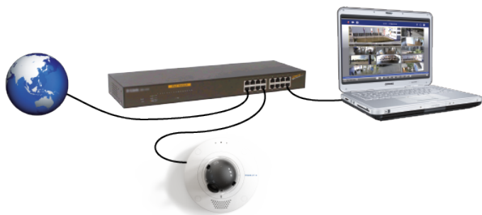
Fig. 17: Alimentazione tramite interruttore PoE in base allo standard PoE Plus (802.3at-2009).
