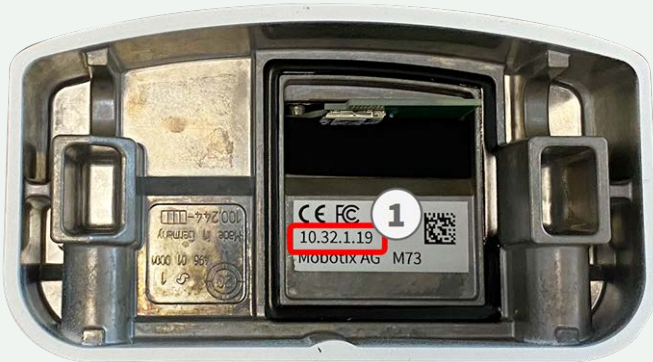
Abb. 6: IP-Adresse auf der Rückseite des Kameragehäuses
