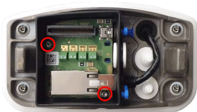
Abb. 67: Connector Box RJ45 (Draufsicht) mit zwei Schrauben (rot hervorgehoben) an Montageplatte montieren
