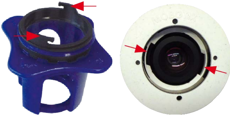
Abb. 87: Einsetzen des Schutzglases mit dem Objektivschlüssel
