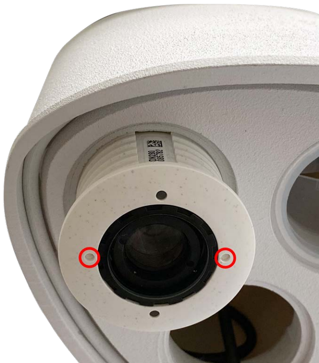
Abb. 13: Sensormodul in Modulgehäuse einsetzen
