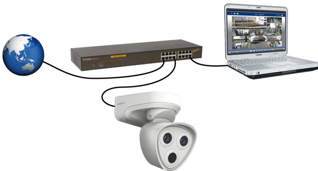
Abb. 52: Stromversorgung über PoE-Switch gemäß PoE Plus (802.3at-2009).
