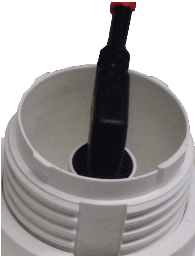
Abb. 11: Rückseite des Blindmoduls mit angeschlossenem Steckverbinder
