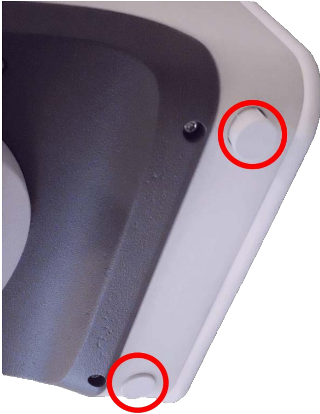
Fig. 92: Retire los tapones de caucho
