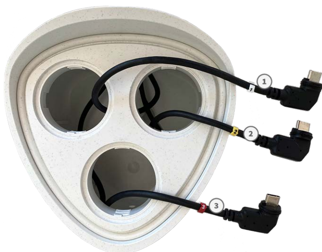
Fig. 9: Cables del módulo de sensor numerados
