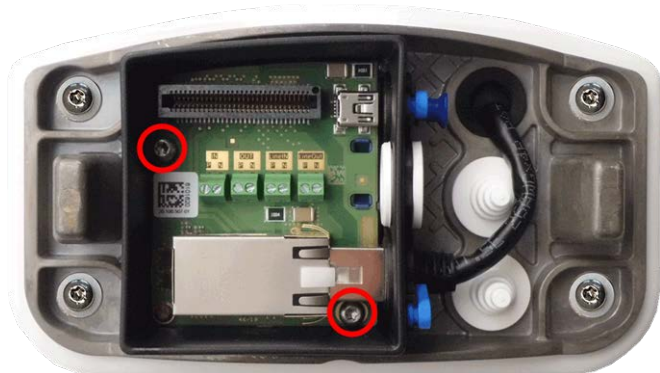
Fig. 67: Monte el Connector Box RJ45 (imagen superior) con los dos tornillos (resaltados en rojo) en la placa de montaje
