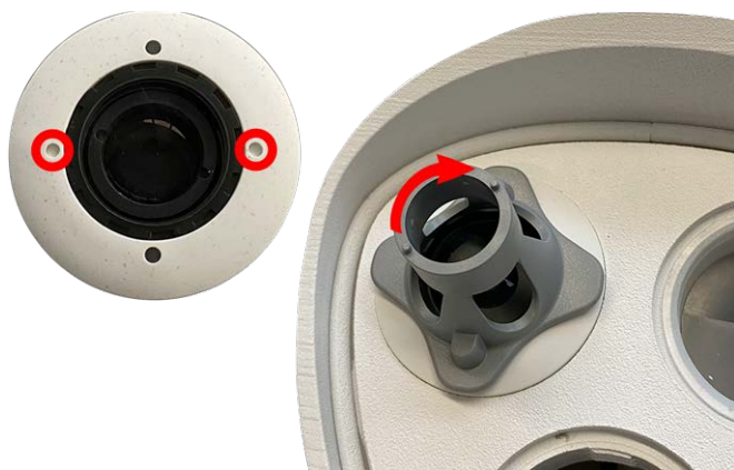
Fig. 14: Bloquee el módulo de sensor
