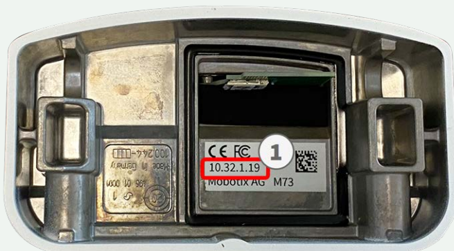
Fig. 6: Dirección IP en la parte posterior de la carcasa de la cámara
