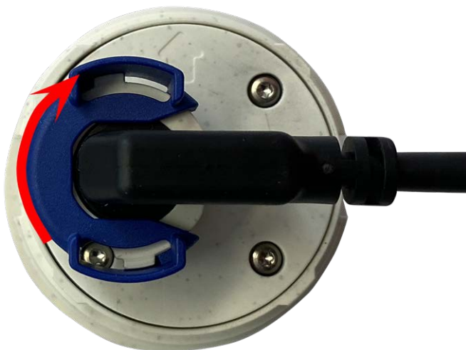
Fig. 12: Bloquee el módulo de sensor
