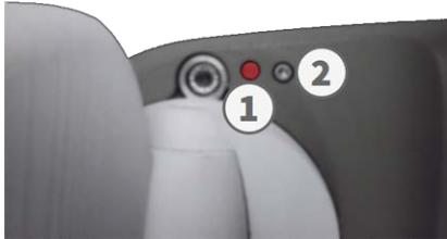
Fig. 75: Vista de la MOBOTIX M73 desde abajo con el LED ① y el tornillo con sellado ② que oculta la llave dentro del chasis de la cámara
