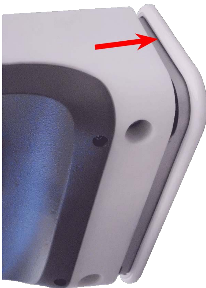
Fig. 70: Presione la cámara sobre la placa de montaje
