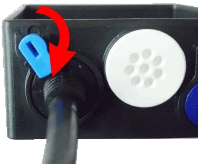
Fig. 66: Bloquee el cable de red en la caja de conectores
