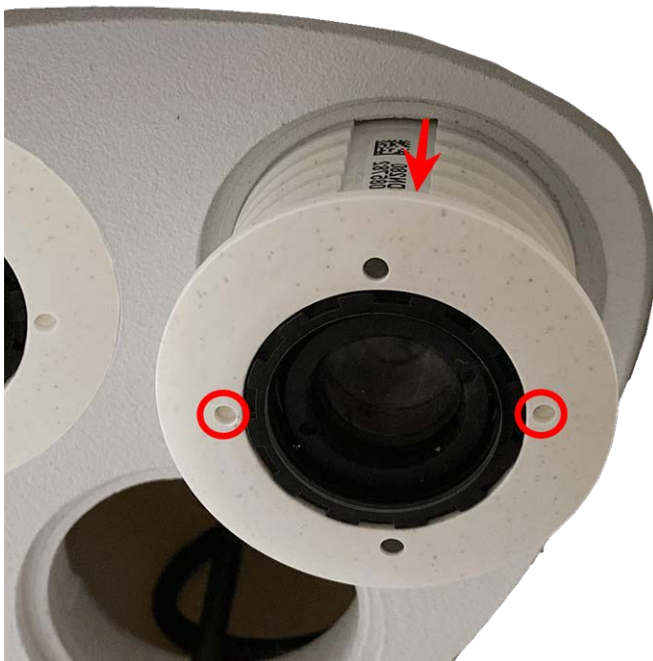
Fig. 24: Extracción del módulo de sensor desde la carcasa del módulo
