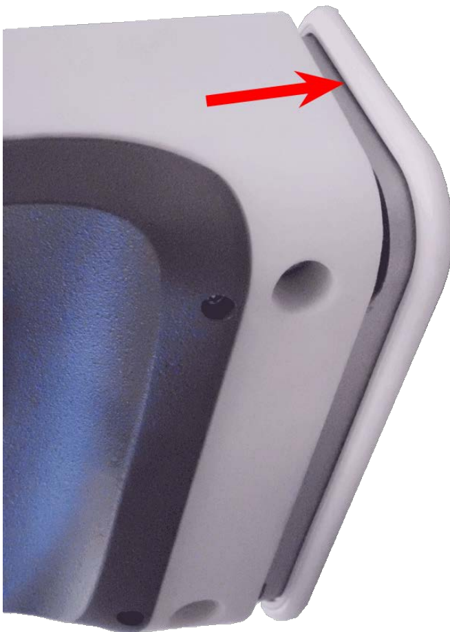
Fig. 70: Appuyez sur la caméra au niveau de la plaque de montage
