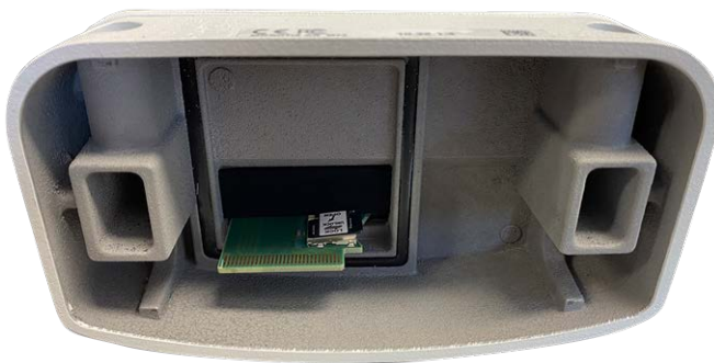
Fig. 95: Ouvrez le boîtier de la caméra
