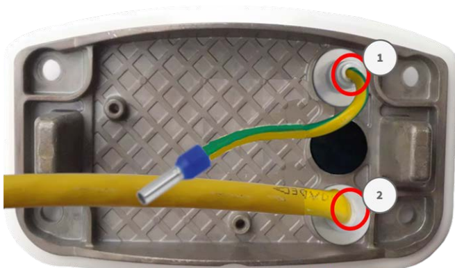
Fig. 36: Plaque de montage avec fil de terre et câble réseau
