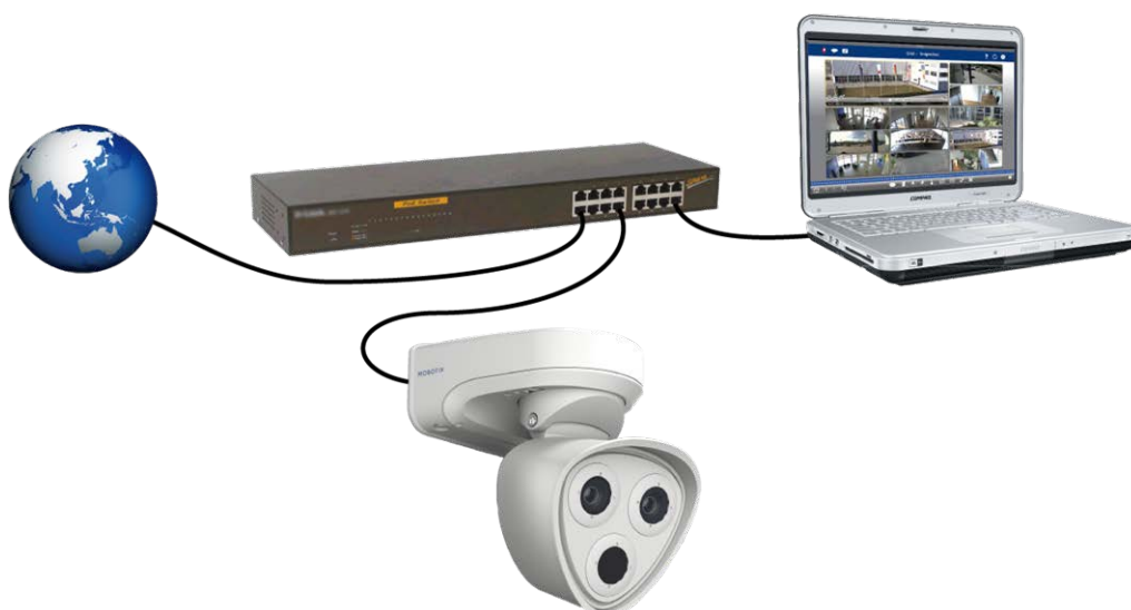
Fig. 52: Alimentation électrique à l'aide d'un commutateur PoE conformément à PoE Plus (802.3at-2009).
