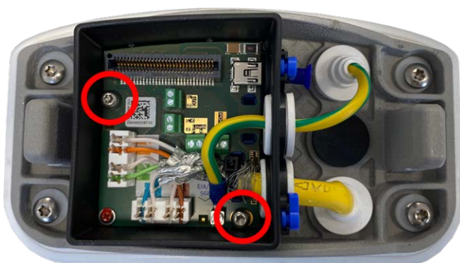
Fig. 64: Montez le Connector Box LSA (vue de dessus) à l'aide des deux vis (surlignées en rouge sur la figure) sur la plaque de montage
