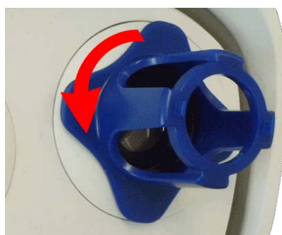
Fig. 84: Tournez le module de capteur à fond dans le sens inverse des aiguilles d'une montre
