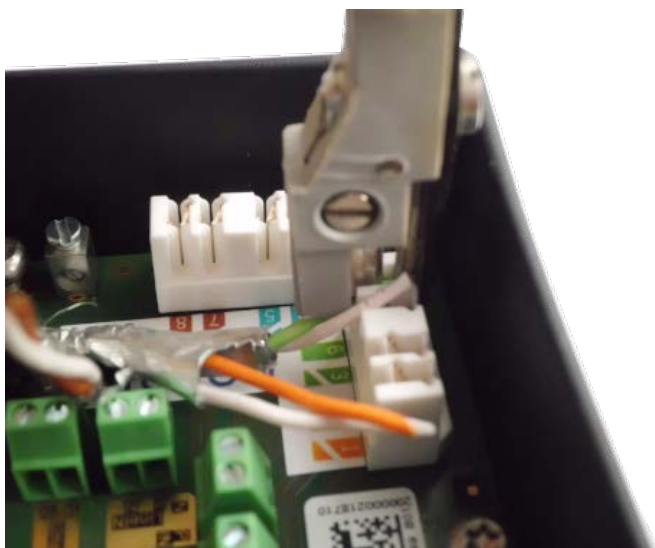
Fig. 60: Fils réseau connectés à l'aide de l'outil LSA+/Krone
