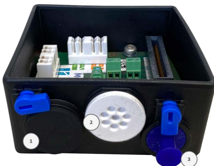
Fig. 53: Connector Box LSA avec bouchon en caoutchouc noir C.3 ① , bouchon en caoutchouc à un fil C.4 ② , prise USB ③ et deux verrous bleus
