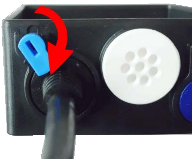
Fig. 66: Bloquez le câble réseau dans le boîtier de connexion
