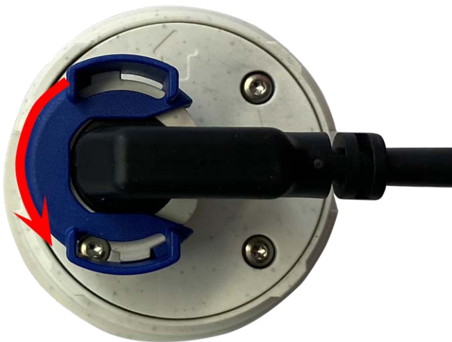
Fig. 21: Déverrouillez le câble du module de capteur
