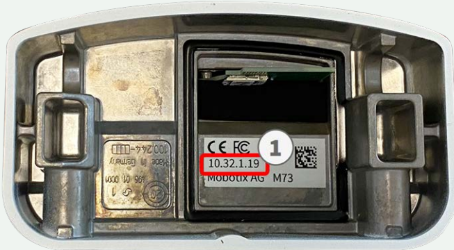
Fig. 6: Adresse IP au dos du boîtier de la caméra
