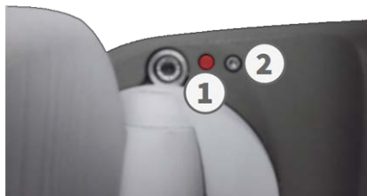
Fig. 75: Vue de la MOBOTIX M73 du dessous avec voyant ① et vis avec joint ② qui masque la clé à l'intérieur du boîtier de la caméra
