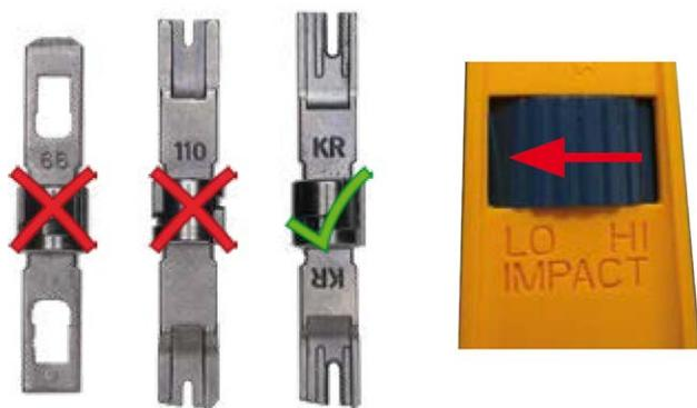
Fig. 59: Strumento LSA+/Krone impostato su impatto LOW (basso)
