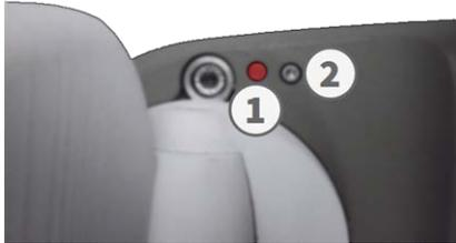
Fig. 75: Vista della MOBOTIX M73 dal basso con LED ① e vite con guarnizione ② che nasconde il tasto all'interno del corpo della telecamera
