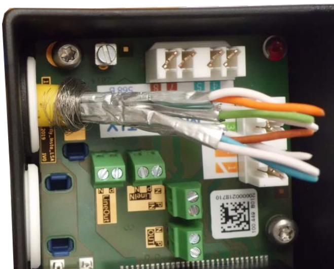
Fig. 57: Cavo di rete inserito, tappo posizionato correttamente
