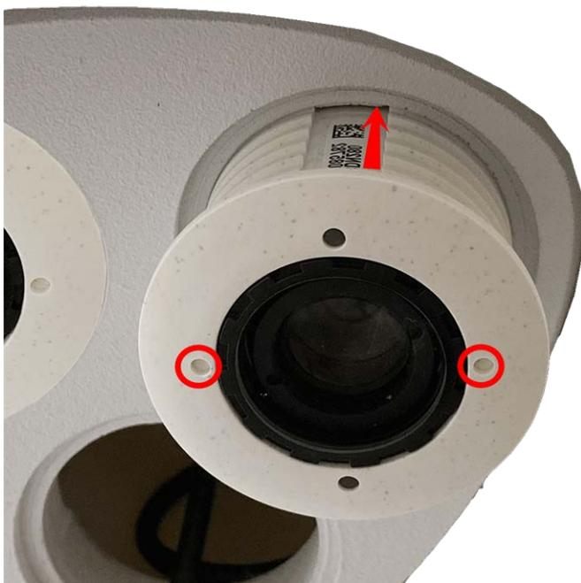
Fig. 26: Inserire il modulo sensore nella piastra anteriore Thermal
