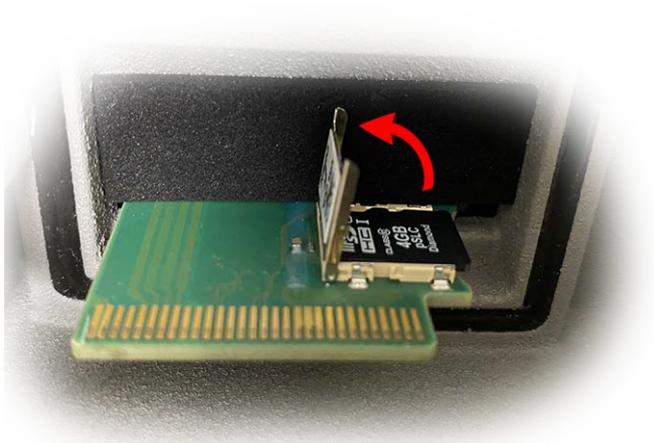
Fig. 96: Sbloccare il supporto della scheda microSD
