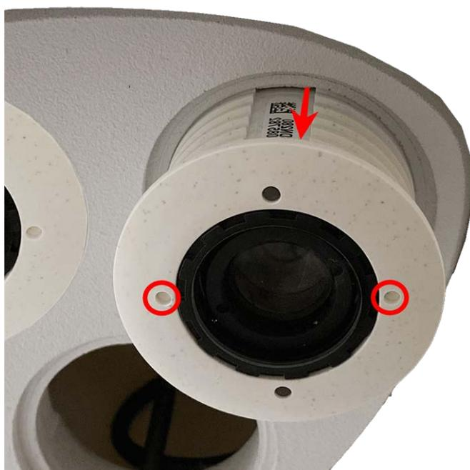
Fig. 24: Rimuovere il modulo sensore dall'alloggiamento del modulo
