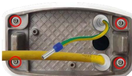
Fig. 51: Installata e pronto per Connector Box LSA
