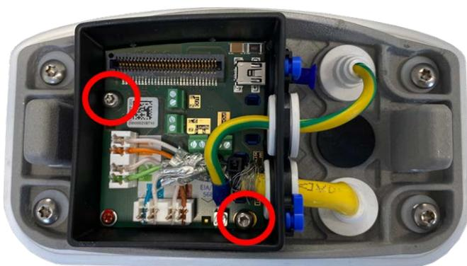
**Fig. 64:** Montare la Connector Box LSA (vista dall'alto) utilizzando le due viti (evidenziate in rosso nella figura) sulla piastra di montaggio
