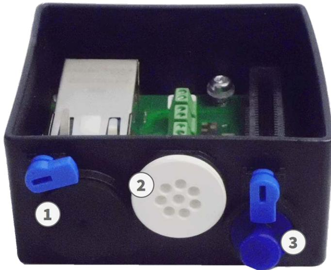
Fig. 65: Connector Box RJ45 con tappo in gomma nero C.3 ①, tappo in gomma a filo singolo C.4 ②, tappo USB ③ e due fermi blu
