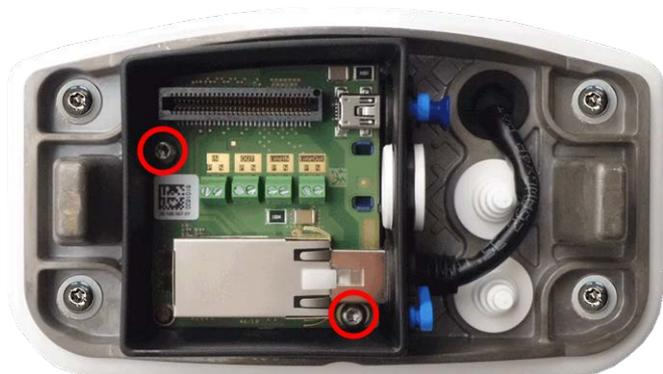
**Fig. 67:** Montare la Connector Box RJ45 (vista dall'alto) utilizzando le due viti (evidenziate in rosso nella figura) sulla piastra di montaggio
