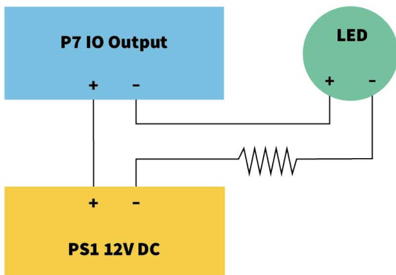
Fig. 68: Esempio: commutazione di un LED
