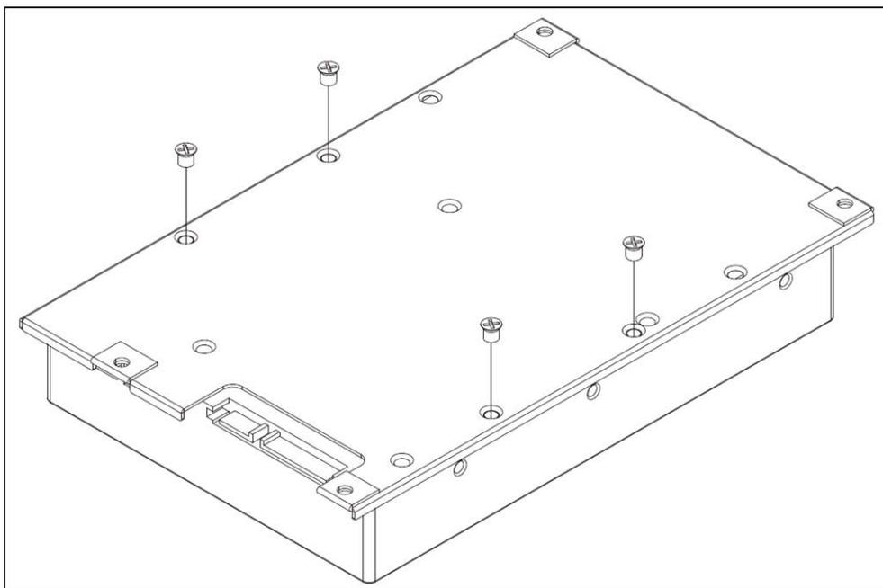
4. Rimontare il rack HDD nella posizione originale. Non è richiesto alcun cavo SATA; l'unità HDD viene collegata automaticamente.
