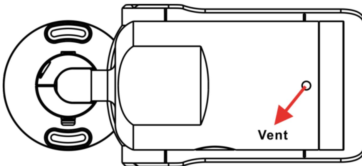
**ATTENTION!** À basse température et/ou lorsque le taux d'humidité est important, l'humidité peut s'accumuler derrière la vitre avant en l'absence de dessiccant si la caméra n'est pas mise sous tension immédiatement après l'installation !
