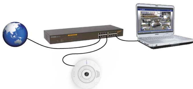
Abb. 17: Stromversorgung über PoE-Switch gemäß PoE Plus (802.3at-2009).
