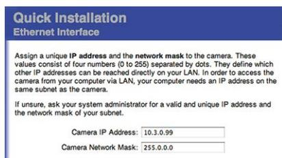
Fig. 22: Impostazioni di rete nell'interfaccia Web della telecamera.
