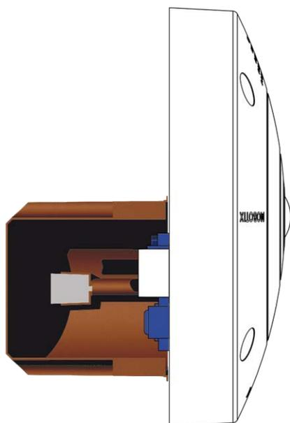
Fig. 6: Vista laterale di MOBOTIX Q71 con presa a muro a incasso
