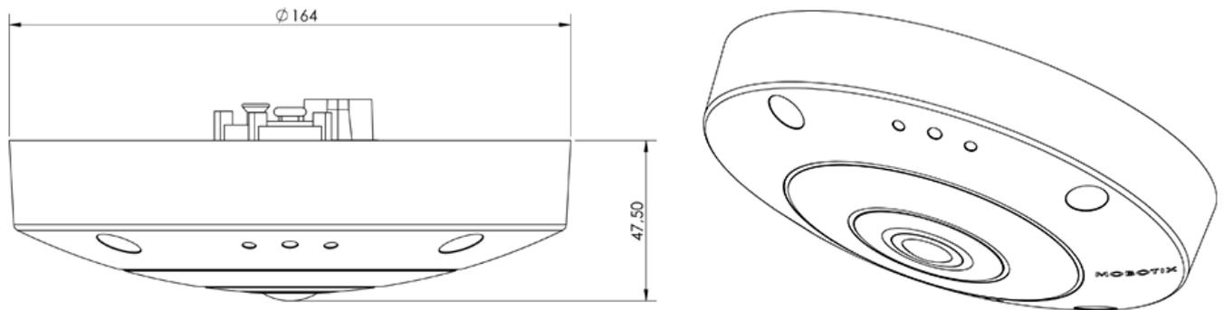
Fig. 5: MOBOTIX Q71: Tutte le misurazioni in mm
