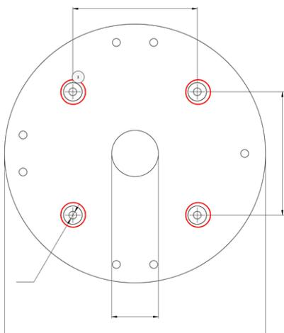
3. Se si utilizza il set da 0°, chiudere le aperture dei cavi ② non necessarie con i tappi di chiusura inclusi. Fissare ciascuno di essi dall'interno utilizzando un piccolo dado esagonale.
