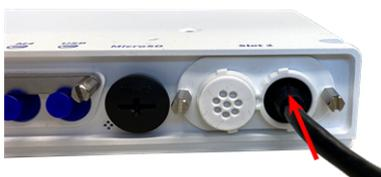
Abb. 40: Drücken Sie den Stecker fest ein, bis der blaue Dichtring einrastet.
