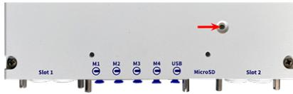
Abb. 41: Kamera-LED am Kameragehäuse
