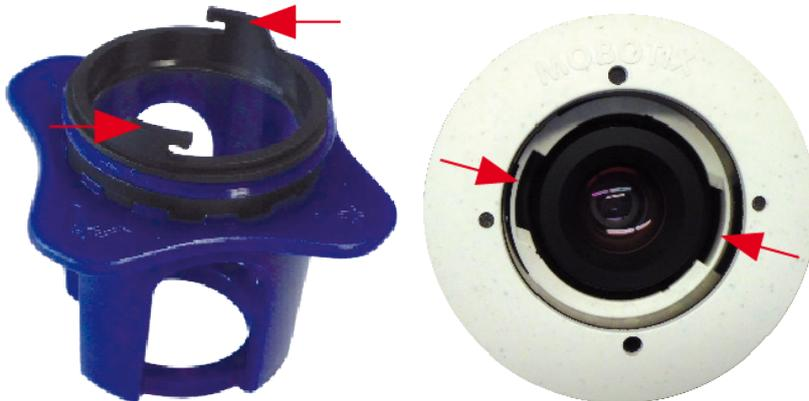
Abb. 54: Einsetzen des Schutzglases mit dem Objektivschlüssel
