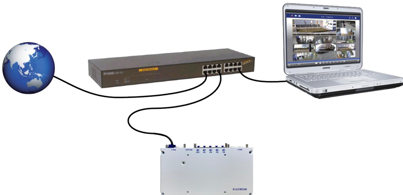
Abb. 39: Stromversorgung über PoE-Switch gemäß PoE Plus (802.3at-2009)
