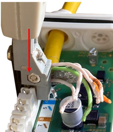
Abb. 25: Mit Krone LSA-Plus-Anlegewerkzeug angeschlossenes Netzkabel
