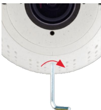
12. Ajuste el módulo de sensor temporalmente apuntando hacia la dirección de visualización deseada.
