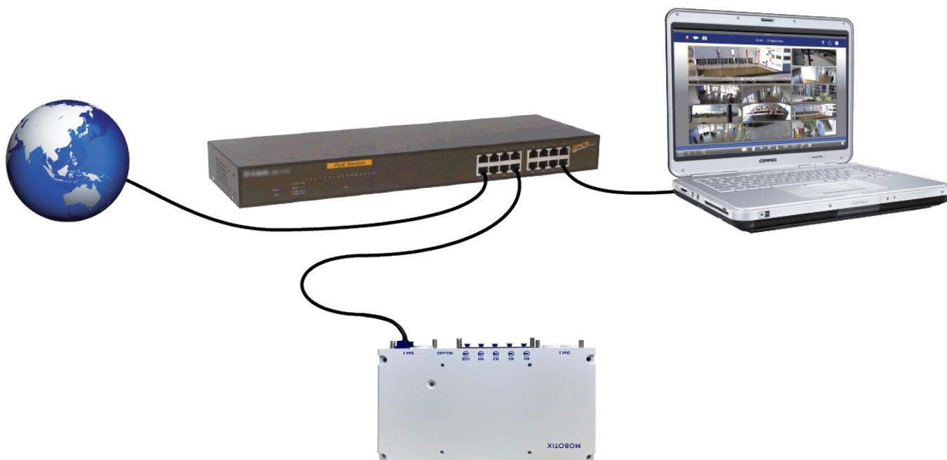
Fig. 39: Fuente de alimentación mediante un conmutador PoE según la PoE Plus (802.3at-2009)
