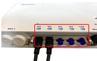
Fig. 37: 4 puertos de conexión de módulos y 1 interfaz USB-C
