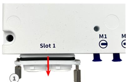
Fig. 31: Retire la cubierta de la ranura de la tarjeta de interfaz
