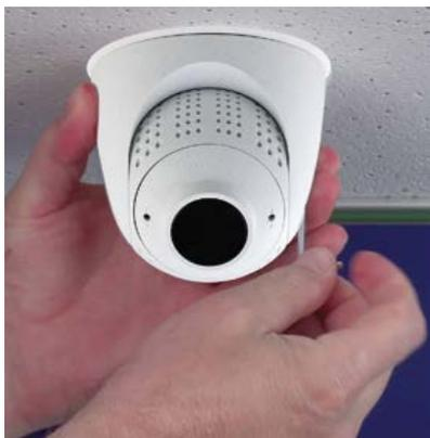
6. Ajuste el módulo de sensor temporalmente apuntando hacia la dirección de visualización deseada.
