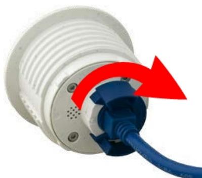
9. Presione el módulo de sensor en PTMount de modo que las letras que indican **MOBOTIX** giren 90 grados hacia la izquierda en comparación con las letras **TOP/OBEN**.
