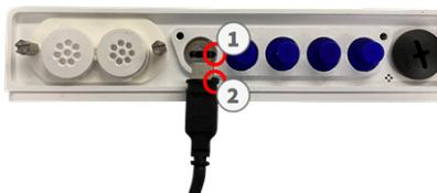
**ATENCIÓN!** Si el cable del módulo no está conectado correctamente, la cámara no reconocerá el sensor.
