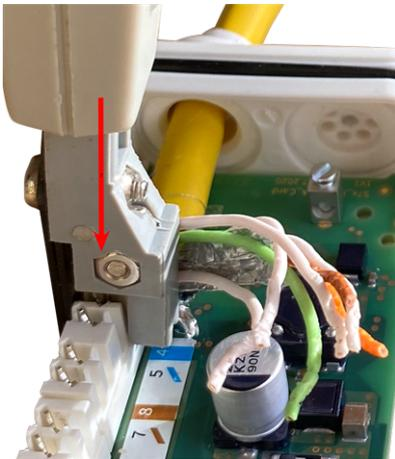
Fig. 25: Cables de red conectados mediante la herramienta LSA+/Krone
