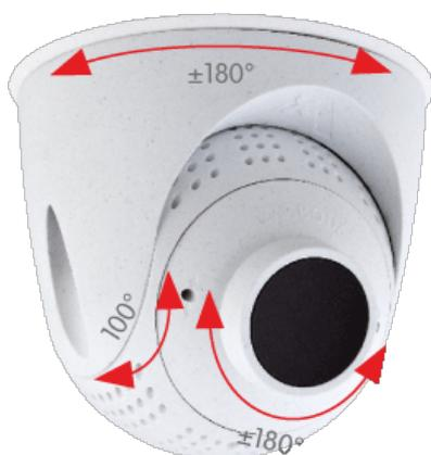
7. Asegúrese de que la etiqueta **MOBOTIX** de la pieza apunta hacia arriba. Si no es así, afloje los dos tornillos de sujeción con la llave Allen de 2 mm y gire la pieza. Apriete ligeramente los dos tornillos de fijación.
