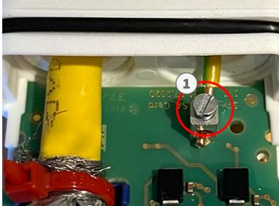
Fig. 27: Cable de tierra conectado al borne
