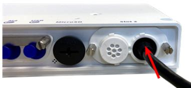
Fig. 40: Presione el enchufe firmemente hasta que la junta tórica azul encaje en su sitio.
