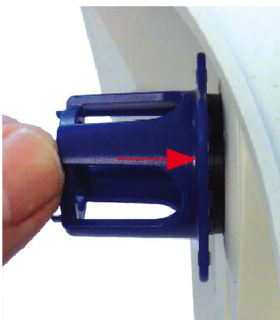
Fig. 55: Presione con fuerza para insertar el cristal de protección del objetivo y gírelo para encajar en su sitio
