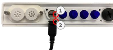
**ATTENZIONE!** Se il cavo del modulo non è inserito correttamente, la telecamera non riconosce il sensore.
