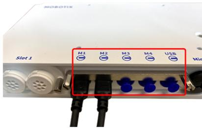
Fig. 37: 4 porte per connettore modulo e 1 interfaccia USB-C
