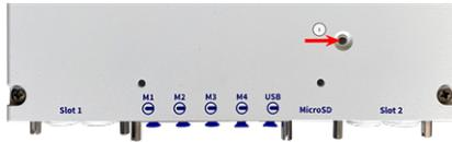
Fig. 41: LED della telecamera sulla parte superiore del corpo della telecamera
