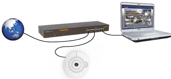
Abb. 17: Stromversorgung über PoE-Switch gemäß PoE Plus (802.3at-2009).
