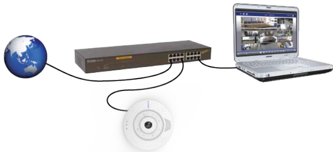
Fig. 17: Fuente de alimentación mediante un conmutador PoE según la PoE Plus (802.3at-2009)
